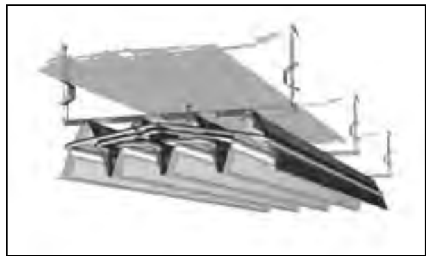
Montage af Carat H med pendel.
